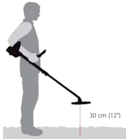
Figura 17 – Posición correcta del detector para la cancelación de ruido
